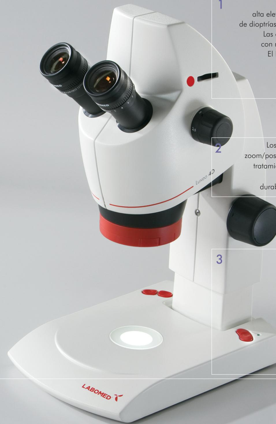
**1** Los oculares enfocables con alta elevación y clic stops\* para la selección de dioptrías ofrecen comodidad y conveniencia. Las anteojeras son rígidas, anti reflejos y con molde recubierto de antimicrobiano. El Luxeo 4D incluye una cámara digital de 5MP con ranura para la tarjeta de memoria SD, un botón de capturar/grabar imagen, y el software PixelPro™.
